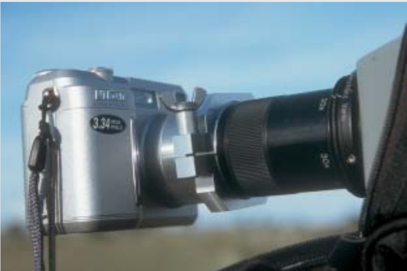
Lösung eines kleinen technischen Problems: Passende Adapter für die Verbindung zwischen Digitalkamera und Spektivokular.
