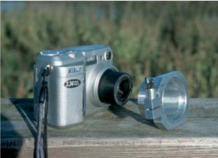
Lösung eines kleinen technischen Problems: Passende Adapter für die Verbindung zwischen Digitalkamera und Spektivokular.
